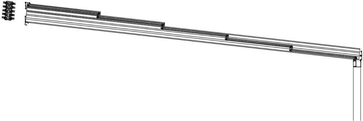
Techo Skyglass al 80% de apertura cerrado. 1 hoja fija y 4 hojas móviles
